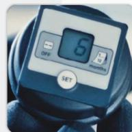
L'unità di controllo elettronica con compensazione della temperatura mostra il periodo di erogazione / lo stato di esercizio - Display LCD e pulsante Impostazione: 1, 2, 3, ... 12 mesi.
