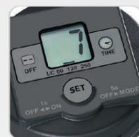
Display LCD, con pulsante di impostazione, indica il periodo di erogazione, la misura dell'unità da 60, 120 a 250 cm<sup>3</sup> e lo stato d'esercizio.
